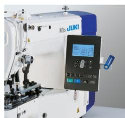
Painel LCD padrão: Será instalado na cabeça da máquina
