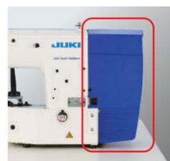
Caixa de controle integrada com a cabeça da máquina
