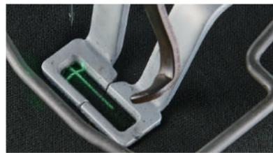
Exemplo do guia de fio do tipo H instalado.
