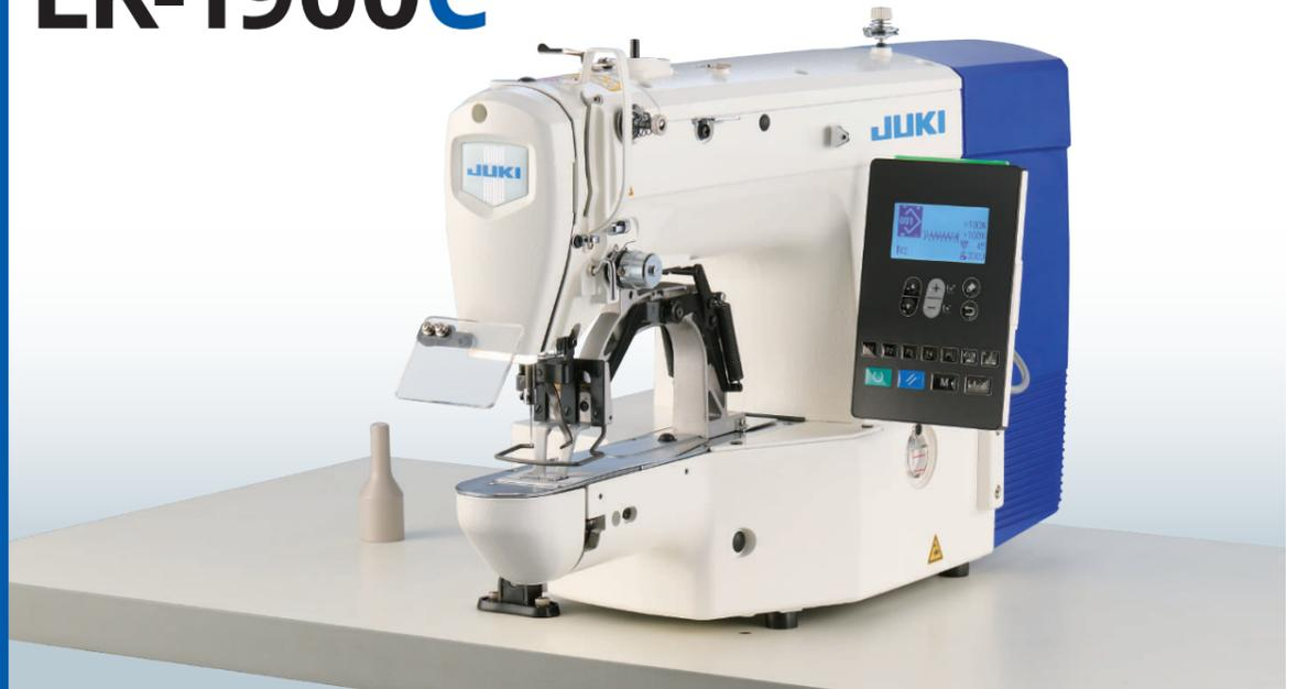
A velocidade máxima de costura de 3.300 sti/min e a maior velocidade de corte de fio ajudam a reduzir o tempo total do ciclo, alcançando maior capacidade de produção. O LK-1900C é uma máquina de bartack de alta velocidade controlada por computador, com excelente qualidade de costura. Ela é fornecida como padrão com 100 padrões de costura diferentes para apoiar uma ampla gama de costuras.
