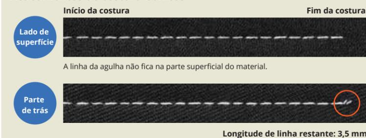
A DDL-8000C pode produzir o efeito de fio residual mais curto ao realizar um ponto condensado.
