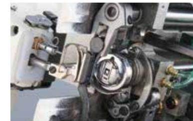
Lado inferior da lâmina de corte de fio
