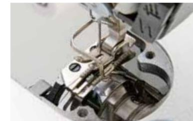
Lado superior da lâmina de corte de fio
